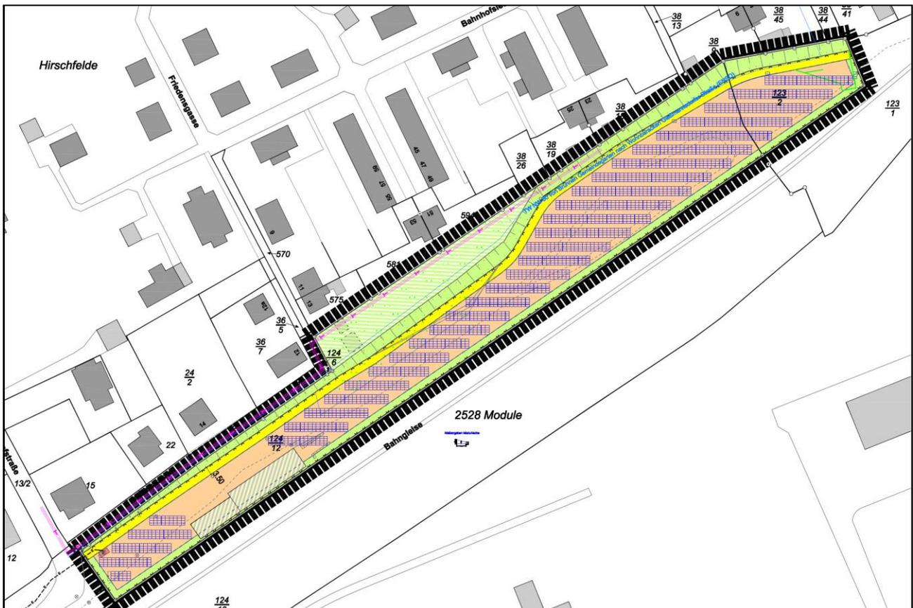
**Bild 1:** Karte des B-Plan-Gebietes mit den geplanten Solarmodulstandorten
